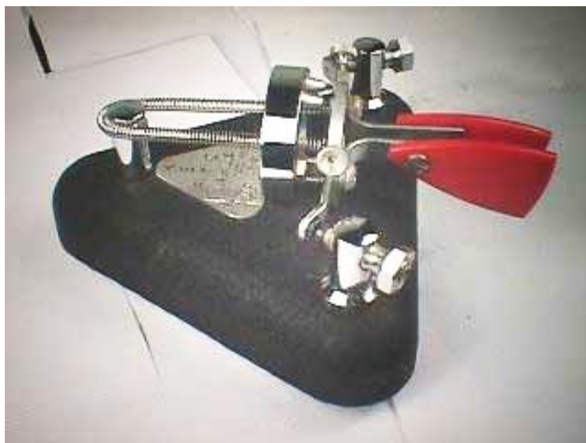
Obr. 14. Dvoupákový manipulátor systému FYO (60. léta)
