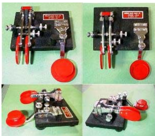
Obr. 10. Combo (ruční klíč a squeeze manipulátor) firmy Brown Brothers
