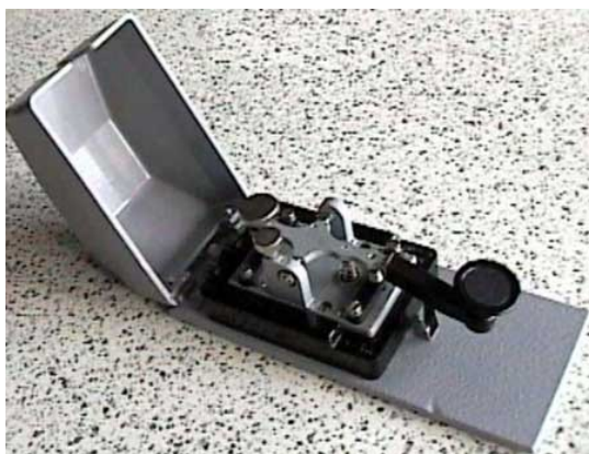
Obr. 3. Německý ruční klíč Junker (1939, Junkers Morsetaste, proto někdy nesprávně nazývaný Junkers)
