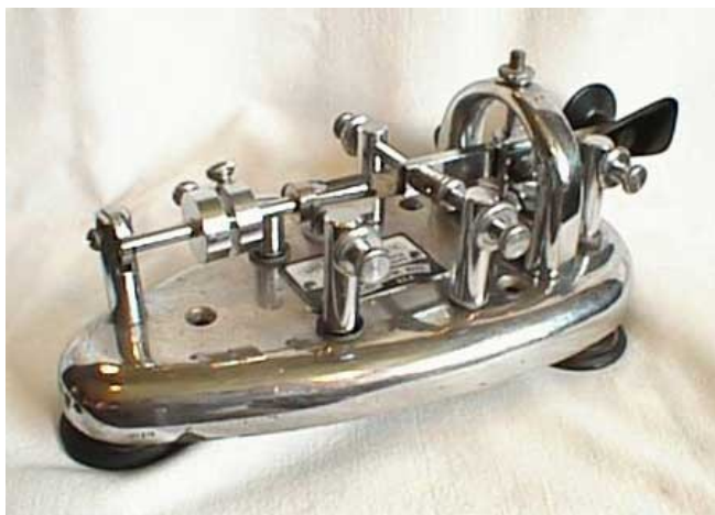
Obr. 9. Klíč McElroy Teardrop (systém Vibroplex, 1939)
