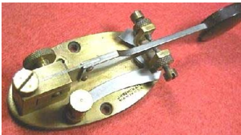
Obr. 6. Stranový dvojčinný klíč (sideswiper) firmy J. H. Bunnell
