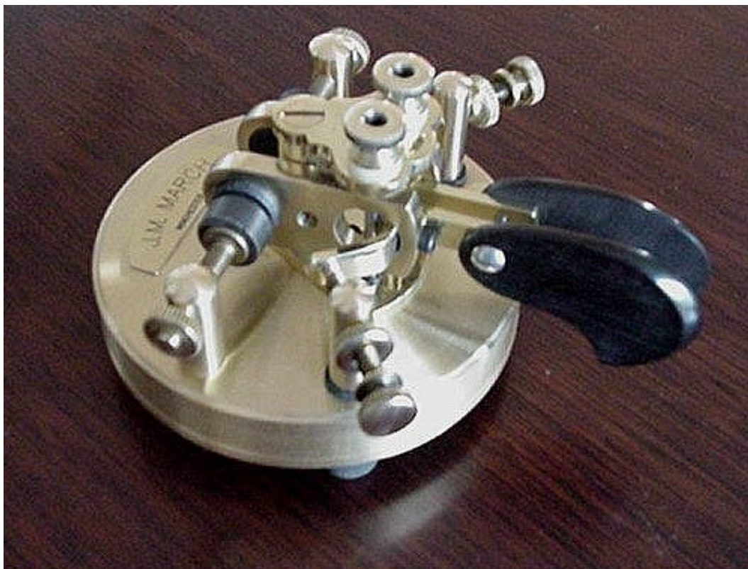
March R-3a (K4QU) používá dvojici vzájemně se odpuzujících magnetů.
