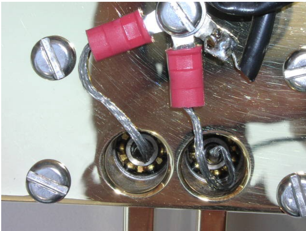
Jones Iambic používá ke spojení pák se zemí silné zemnicí pásky. Jsou vidět také otevřená kuličková ložiska.
